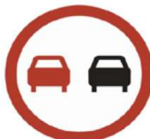
431 ممنوع التجاوز Overtaking Prohibited
